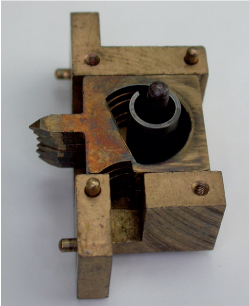
Abb. 12: Beispiel für Markierspitzen mit Gleitbahn nach DRP 305832.
