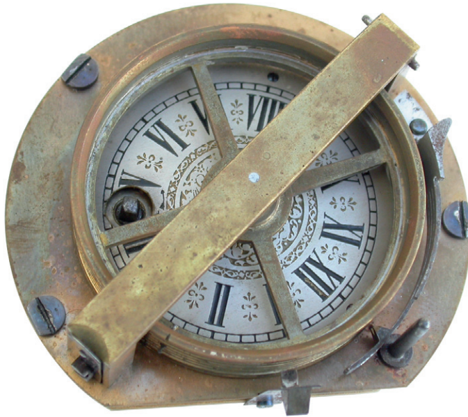
Abb. 4: Uhrwerk Typ 2. Zifferblattseite mit unbeschriftetem Steg (Befestigungsbügel). Rechts unten ist der Markierfedersatz zu erkennen.
